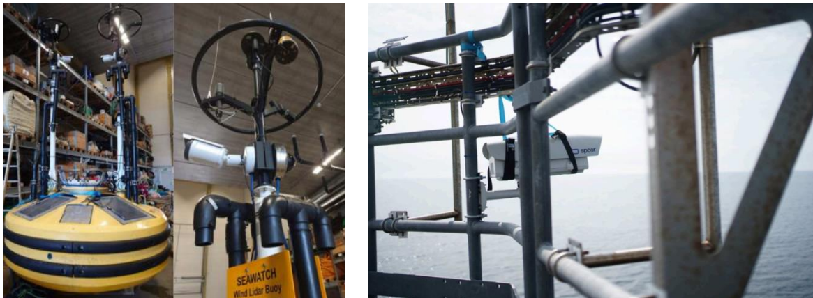
Joonis 3-6. Vasakul: Fugro SEAWATCH poi laos enne kasutuselevõttu. Linnuvaatluskaamerad on paigaldatud kahele postile. Paremal: turbiinile paigaldatav kaamera (Avigilon 61C-H5PRO-B). Albaania. (Spoor, 2024)
